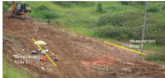
Figura 8. O posicionamento das duas linhas de análises sísmicas, uma no eixo da futura estrada e a outra fora do domínio da concessionária, dentro do terreno vizinho.
